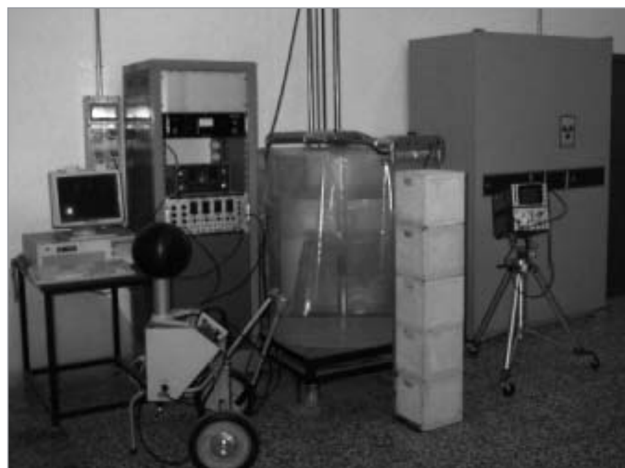
Fig. 6. Vista de la cuba moderadora, rellena de H 2 O desmineralizada. Sobre ella se observa el sistema de posicionamiento del detector miniatura de BF 3 para medida de neutrones térmicos; a la izquierda, el sistema de toma de datos y el PC que permite controlar la posición del detector y registrar las medidas. También aparece en la foto un veterano dosímetro de neutrones NEMO (de 6 Li(Eu)).
