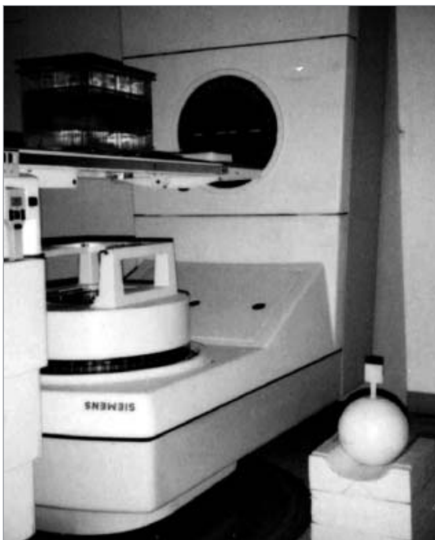
Fig. 1.- Medida de la dosis equivalente con la esfera de parafina con los TLDs.
