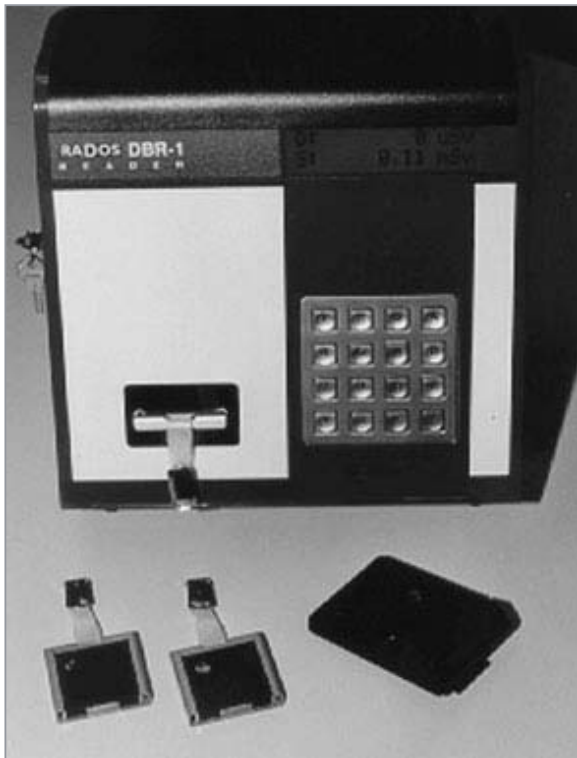
Fig. 7. Prototipo del dosímetro DIS y lecturas.
