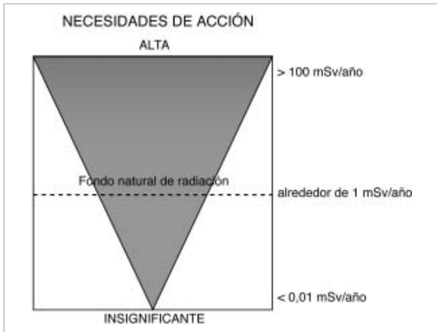
Figura 1. Necesidad de acciones de protección propuestas por la CIPR.
