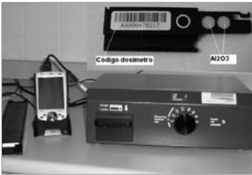
Figura 1: Equipo de lectura InLight de dosímetros OSL. Ampliación de uno de los dosímetros OSL.
