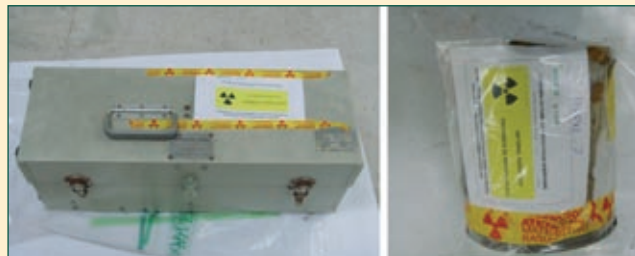
Figura 8. Fuentes y equipos localizados en la campaña tras su caracterización, señalización y acondicionamiento.
