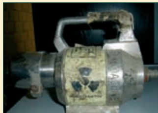
Figura 4. Equipo de gammagrafía industrial con blindaje de uranio empobrecido.
