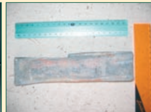
Figura 5. Fuente radiactiva envuelta en lámina de plomoempobrecido.
