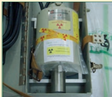
Figura 1. Equipo de medida de densidad de suelos localizado durante la campaña.
