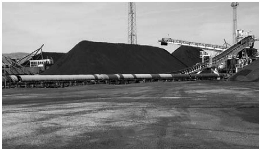
Foto 1: Parque de carbones de una central térmica de carbón.
