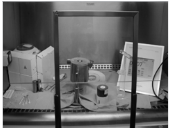
Figura 8. Imagen de la zona de trabajo. Se puede ver el dispensador de dosis (balancín) con la sonda del activímetro tras él y la base de control del mismo, así como el instrumental y el contenedor de residuos tras el castillo de ladrillos de plomo.
