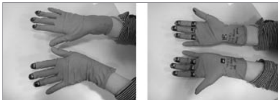
Figura 1: Guantes especiales para la determinación de la distribución de la dosis en mano en instalaciones con radiofármacos PET (11 dosímetros por mano, 8 situados en la palma y 3 sobre las uñas).
