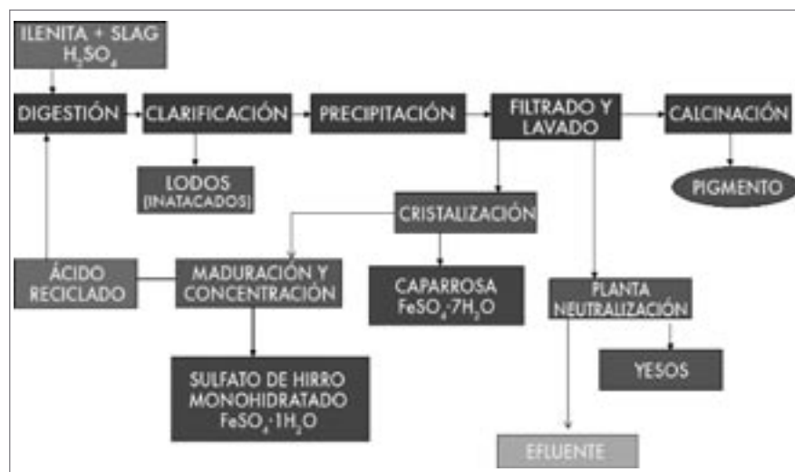
Figura 1. Esquema del proceso industrial para la obtención del dióxido de titanio
