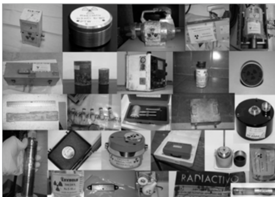
Figura 12. Algunas fuentes radiactivas huérfanas y blindajes retirados en la campaña.
