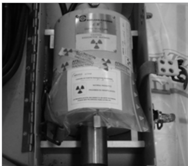
Figura 5. Las fuentes radiactivas declaradas fueron caracterizadas y acondicionadas previamente a su traslado a El Cabril para su gestión segura.
